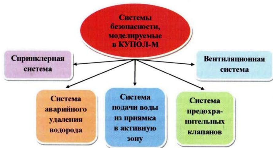
Рисунок 1.4 – Моделируемые в КУПОЛ-М системы безопасности
